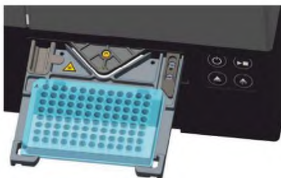
2 pav. Mikroplokštelė ant plokštelės laikiklio su A1 šulinuku viršutiniame kairiajame kampe
